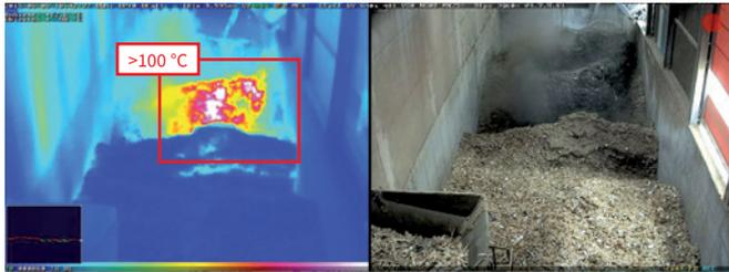
Radiometria termica (TR) Allarme automatico quando i valori della temperatura scendono al di sotto o superano determinati limiti o intervalli
